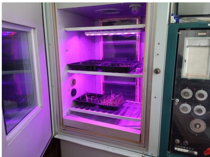
Рис. 2. Гідропонна система малої продуктивності
