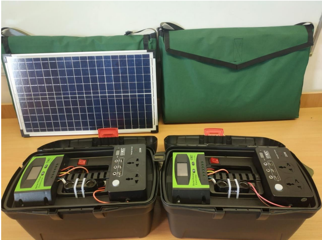
Рис. 14 – Сонячні мініелектростанції, виготовлені працівниками Університету
