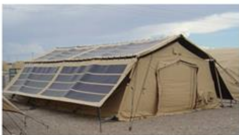
Рисунок 16 – Високоєфективна система енергоживлення військової апаратури в польових умовах від фотоелектричних модулів та суперконденсаторів
