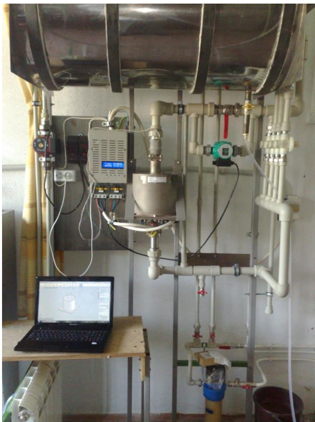
Рисунок 17 – Схема експериментальної установки енергоефективної системи з блоком вимірювання
